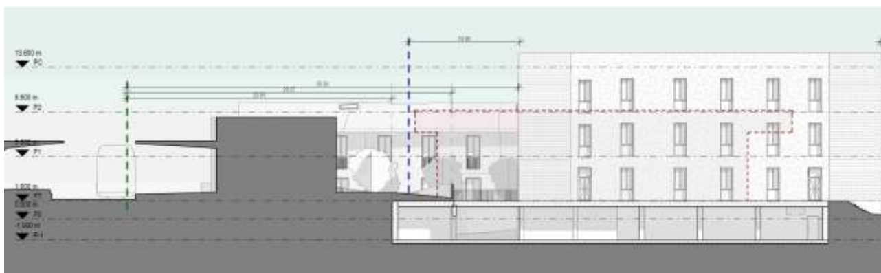
Figura 54 – sezione longitudinale per la determinazione delle distanze dal sedime ferroviario
